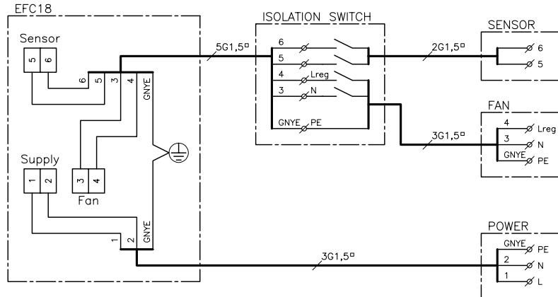
Die Automatik EFC18 und den Temperaturfühler nach dem folgenden Diagramm anschließen (RSHT).
