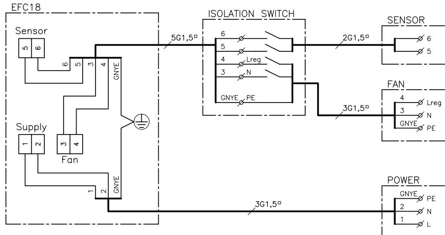
Brancher le EFC18 et le capteur de température, comme indiqué sur le diagramme ci-dessous (RSHT)
