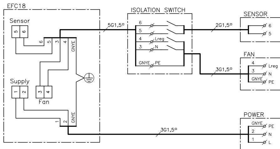
Tilslut EFC18 og temperaturføler efter nedenstående diagram (RSHT).
