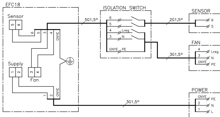
Sluit de EFC18 aan op de temperatuursensor volgens onderstaand schema (RSHT).
